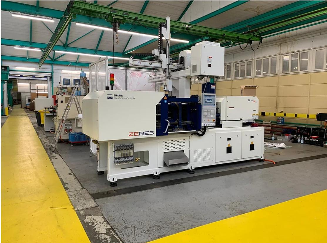
**Bild einer Haitian Spritzgussmaschine bei aXpel injection**
